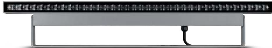
Streamline ist eine Familie linearer feststehender und kippbarer Flutlichter für die Wand- und Bodenmontage. Die feststehende Ausführung sorgt für einen Streiflichteffekt und ist perfekt zur Fassaden- und Wandbeleuchtung geeignet. Sie kann von 0° über -5° bis -10° gekippt werden, wobei das Licht asymmetrisch verteilt wird. Für eine präzise Lichtverteilung wird Streamline in der um 180° kippbaren Ausführung mit Spot 12°, Flood 31° und asymmetrischer Optik angeboten.
