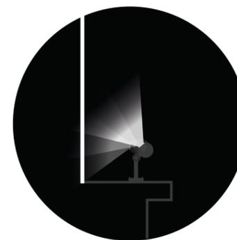
Bei einer Bodenmontage kommt die große Flexibilität der Kippbaren Lichtstange zum Ausdruck, indem sie den Lichtstrahl auf das zu beleuchtende Objekt lenkt.
