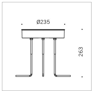
S.5690 DIE FLANSCHPLATTE FÜR BODENMONATGE IST EINZUBETONIEREN
