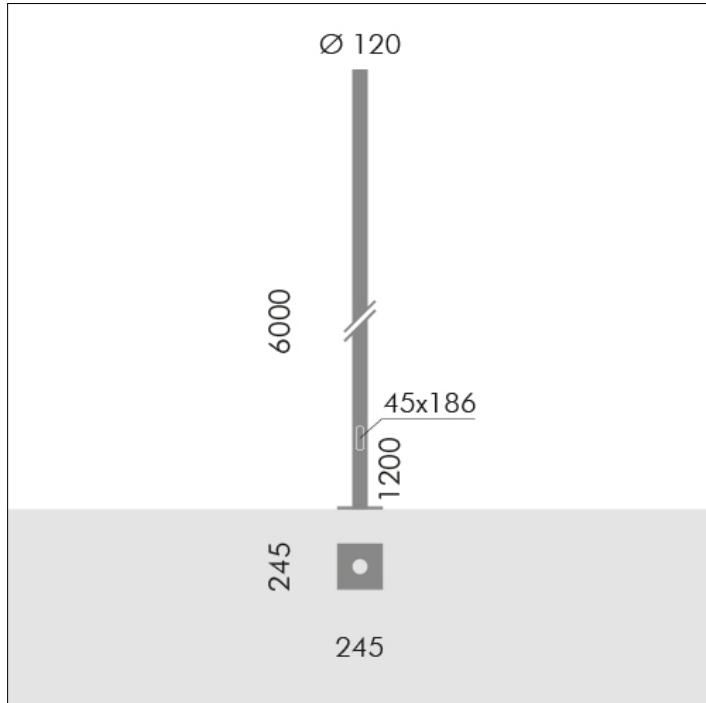
**S.2848****PALO CILINDRICO H 6,0m f.t., Ø120mm FLANGIATO**
