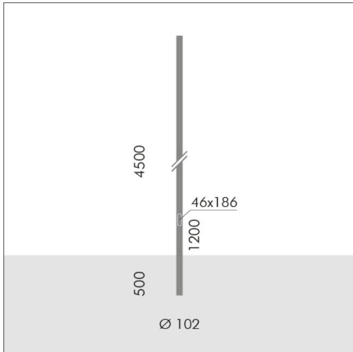
**S.2814****PALO CILINDRICO H 4,5m f.t., Ø102mm DA
