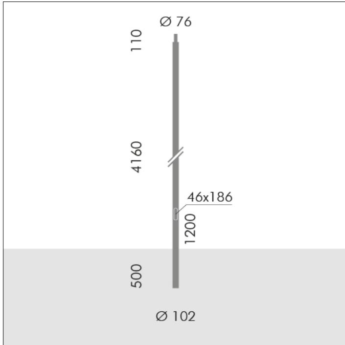
**S.2811****ZYLINDRISCHER MAST H 4,16m Ø102mm MIT
