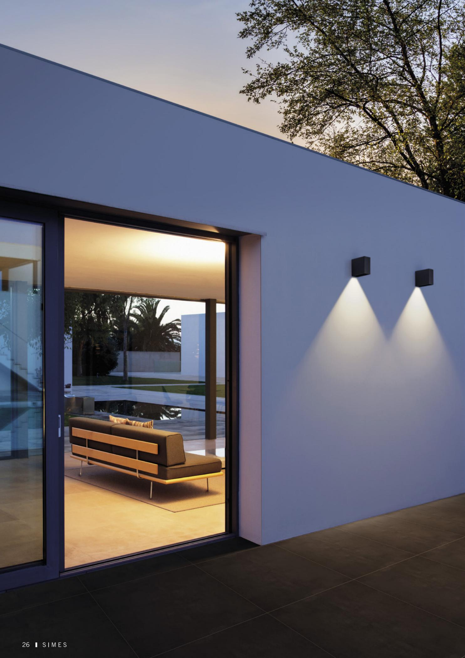
Structure en fonte d'aluminium extrudé EN AB-47100, structure pour potelet en aluminium extrudé EN AW-6060 à haute résistance à l'oxydation. Réflecteur en nylon. Diffuseur en verre trempé transparent. Vis Allen en acier INOX 4A. Appareil pré-câblé avec 5,0m de câble simple en néoprène. Joint en silicone recuit. **Double peinture extra résistante.**
