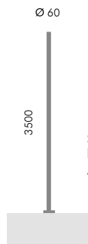
S.2843 PALO CILINDRICO Ø 60 mm FLANGIATO Altezza totale del palo 3500 mm
